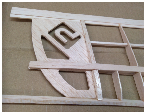
Detail koncového oblouku ucha. Balsové nosníky jdou přes koncový oblouk.
