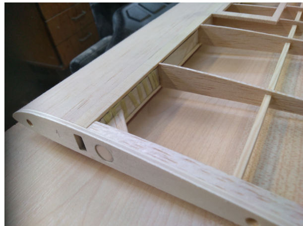
Křídlo střed komplet i se zalepenými magnety
