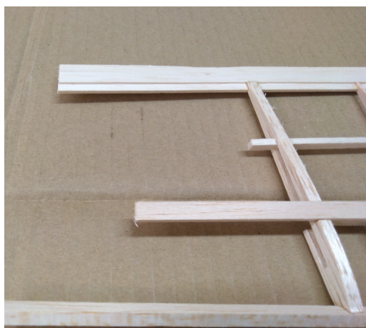
Detail koncového oblouku ucha. Balsové nosníky jdou přes koncový oblouk.
