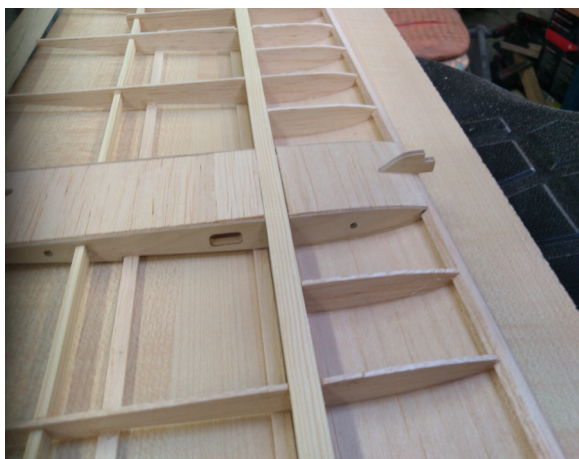
Vylepení středu křídla baslou 1,5 mm a přilepení předního uchycení křídla (překližka 3 mm).
